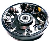
Использование системы PREVI Color Gram вместе с циторотором в режиме цитоцентрифугирования позволяет быстро осадить клетки в образце на предметное стекло для цитологических исследований.
