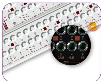
Стрипы АТВ предназначены для полуколичественного определения чувствительности к антимикробным препаратам в полужидкой среде.
